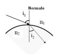
Soit  $0 \le i_1 \le \frac{\pi}{2}$ . Du point I, traçons le plan P tangent à la surface S. Deux cercles de rayons respectifs  $n_1$  et  $n_2$  sont tracés dans le plan contenant la normale IN à P et le rayon incident AI. On a alors:  $IH = ID \sin(i_1) = ID' \sin(i_2) \Rightarrow n_1 \sin(i_1) = n_2 \sin(i_2)$ , c'est à a dire la relation de Snell-Descartes.
